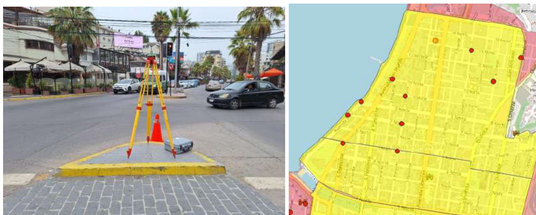
Figura N°4 Muestra medición del PR 584 generado en Población Vergara y en puntos color rojo se indica los PRs remonumentados y en campaña de remediación.
