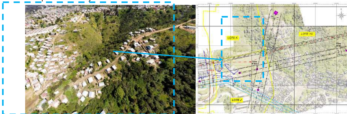
Imagen n° 16: Levantamiento topográfico ante la presencia de ocupaciones informales en fajas de servidumbre de Chilquinta, Sector El Olivar.
